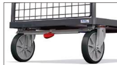
TOTALSTOP – het fetra centrale remsysteem Met slechts één voetbeweging wordt de wieldraaiing en de zwenkbeweging van beide zwenkwielen geblokkeerd. Het rempedaal blijft altijd in het zicht van de gebruiker. Seriematig op alle kastwagens.
